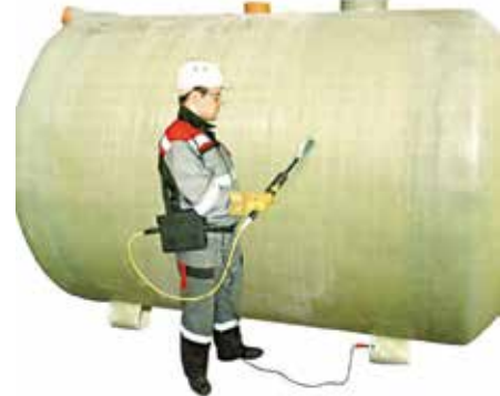
Рис. 6. Электроискровой метод НК: а — принцип действия; б — проведение контроля
