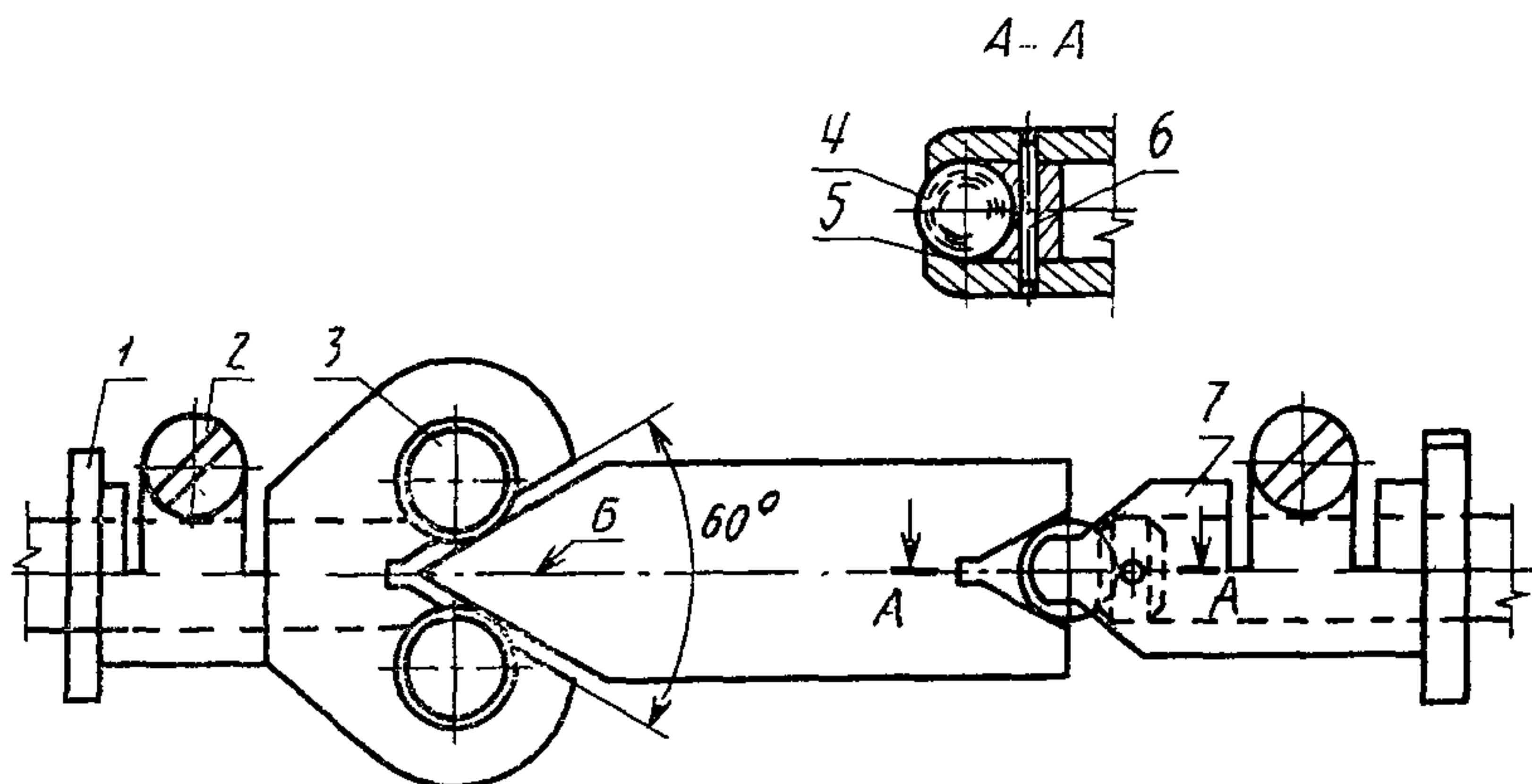
1 — наконечник цилиндрический; 2 — винт ВМ3—6г×8.58.016 ГОСТ 1491; 3 — цилиндр; 4 — шарик 4,763—40 ГОСТ 3722; 5 — пробка; 6 — штифт 1 и 8×8 ГОСТ 3128; 7 — наконечник шариковый
