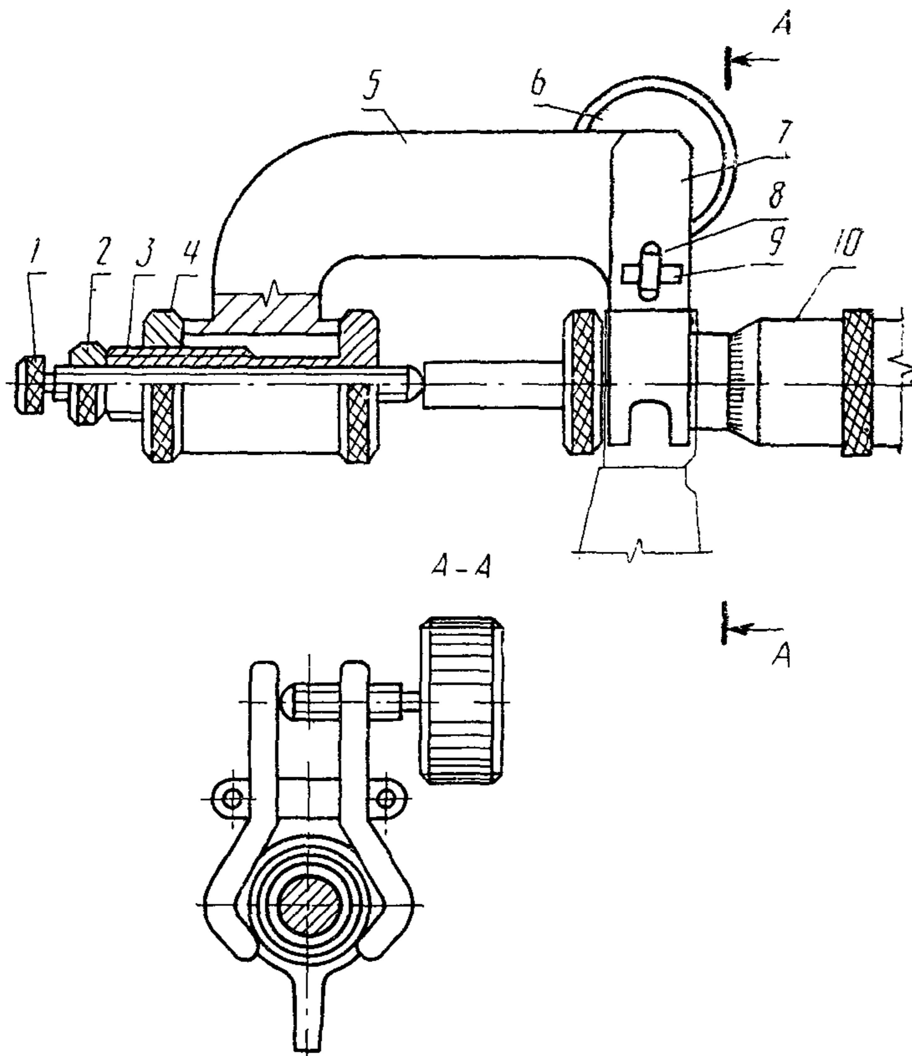
1 — винт; 2 — гайка; 3 — втулка; 4 — гайка; 5 — скоба; 6 — винт; 7 — зажим; 8 — шарнир; 9 — ось шарнира; 10 — поверяемый микрометр
