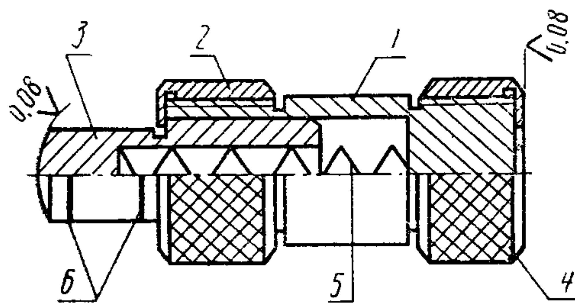
1 — корпус; 2 — гайка; 3 — подвижный наконечник с кольцевыми рисками, соответствующими допускаемым пределам измерительного усилия; 4 — гайка; 5 — пружина; 6 — риски при усилии 5Н и 9Н
