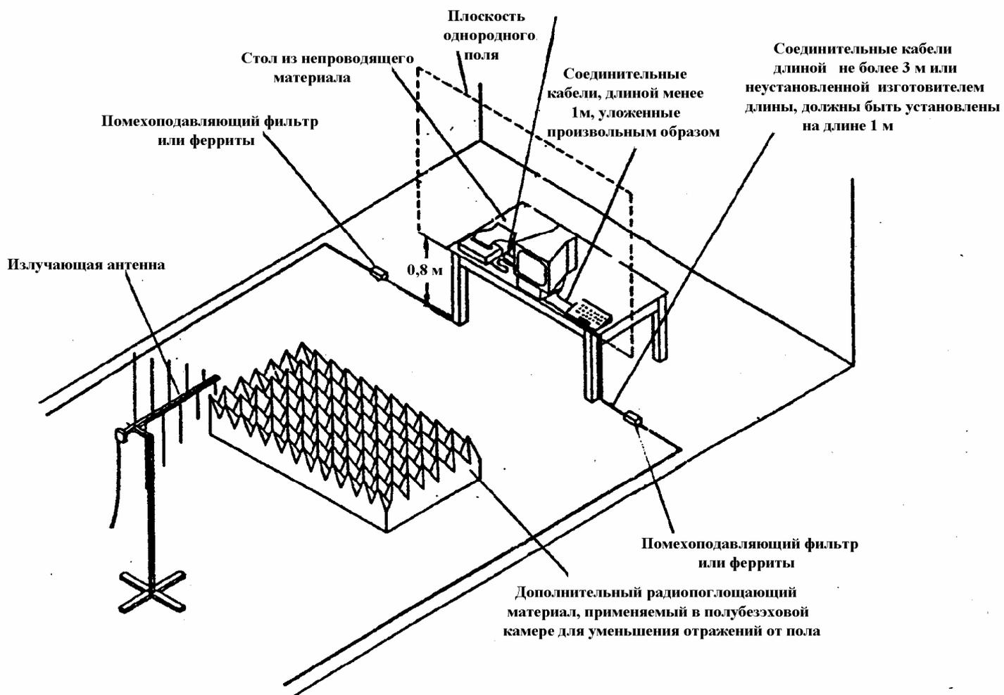
Рисунок 6 - Пример рабочего места для испытаний настольных ТС
