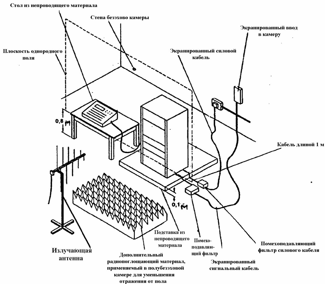
Рисунок 5 - Пример рабочего места для испытаний напольных ТС
