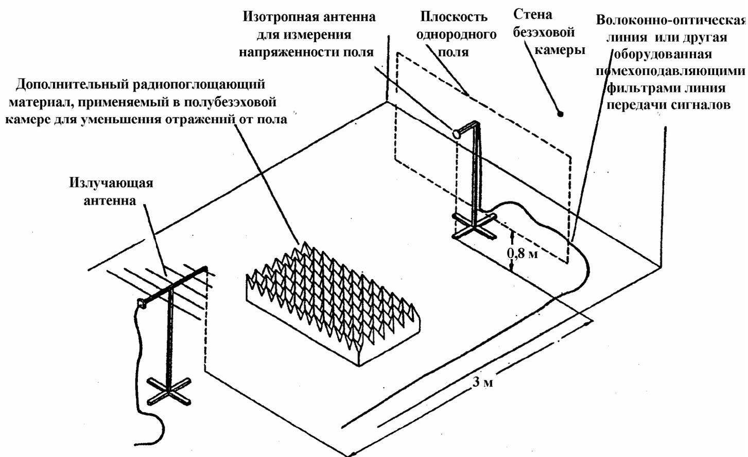
Рисунок 3 - Расположение оборудования при аттестации
