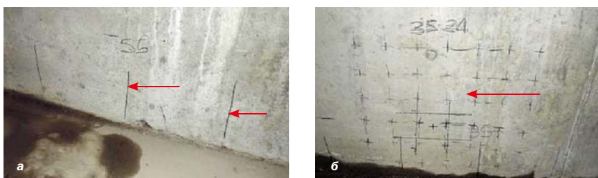
Рис. 4. Разметка поверхности стен для проведения контроля: а — «точечным методом»; б — в режиме «карта» (типичная сетка с ячейками 100 × 100 мм)
