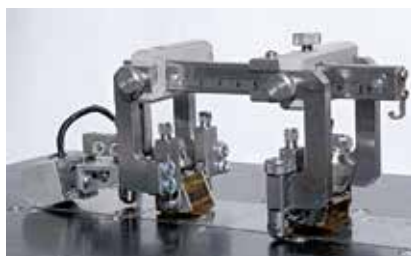
Рис. 5. Сканер для контроля методом TOFD
