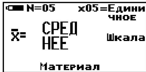
**Среднее** – местоположение текущего среднего значения твердости по  $n$  измерений, число которых также отображается на индикаторе;
