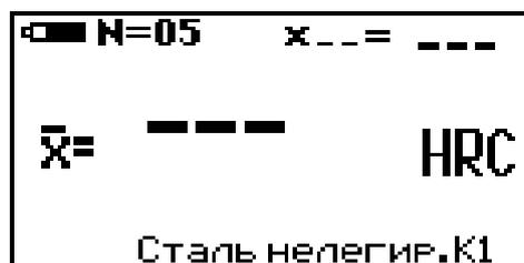
с соответствующими шкалой измерения, группой металлов, номером пользовательской калибровки и числом, ограничивающим количество усредняемых значений, установленными при поставке (при первом включении) или при выключении прибора после проведения измерений.
