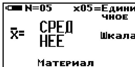
**Среднее** – местоположение текущего среднего значения твердости по **nn** измерений, число которых также отображается на индикаторе;
