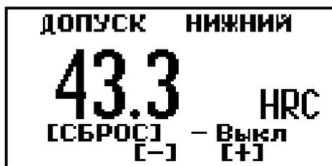
Задание нижнего допуска производится с использованием кнопок
