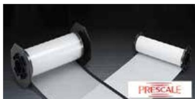
Пленка Prescale используется для измерения силы и распределения давления оказываемого на поверхность контролируемых объектов. Приложенное давление оставляет на пленке, отпечатки красного цвета. Степень давления на участок определяется по насыщенности цветовых отпечатков.
