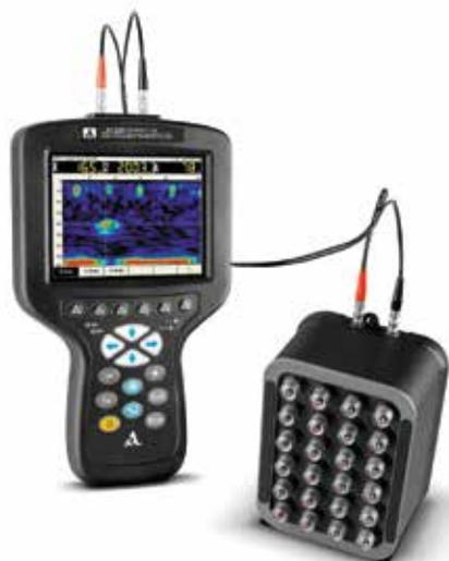
Ультразвуковой дефектоскоп А1220 МОНОЛИТ предназначен для поиска инородных включений, пустот и трещин внутри изделий из железобетона, камня, пластмасс, а так же для измерения толщины и анализа внутренней структуры крупнозернистых материалов. На практике низкочастотный дефектоскоп А1220 МОНОЛИТ обычно используется для толщинометрии и дефектоскопии конструкций из бетона, горных пород и асфальта.
