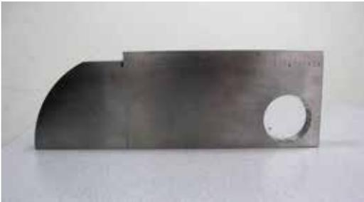
Образец V1 выполнен в соответствии с требованиями международных стандартов [EN 12223](#), ISO2400-1972. Образец V1 (реже K1) изготавливается из углеродистой стали. В отверстие диаметром 50мм запрессовывают цилиндр из органического стекла. Скорость продольных волн в образце (5920 ±30) м/с; сдвиговых (3255 ±15) м/с. Комплект поставки: стандартный образец, паспорт, сертификат о калибровке.
