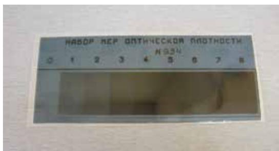
Набор мер оптической плотности предназначен для визуальной оценки оптической плотности радиографических снимков и настройки денситометров. Конструктивно набор мер представляет собой рентгеновскую пленку с прокрашенной основой в виде девяти полей прямоугольной формы разной плотности. Оценка оптической плотности радиографических снимков проводится путем визуального сравнения полей набора и плотности изображения основного металла.
