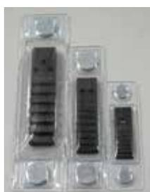
Канавочные эталоны применяются для оценки чувствительности радиографического контроля. Стандартные материалы эталонов чувствительности – сталь, медь, алюминий, титан, никель. Стальные канавочные эталоны производства НТЦ Эксперт выпускаются запаянными в пластиковый чехол с двумя магнитами по краям. Такая упаковка позволяет существенно продлить срок службы эталонов и облегчает их крепление на объектах контроля. Эталоны изготовлены по ТУ 102-372-84.
