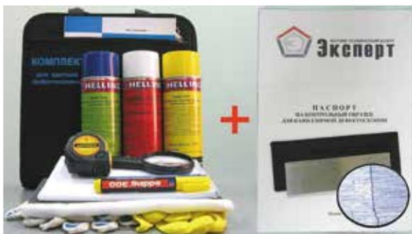
Комплект для капиллярной дефектоскопии предназначен для выявления поверхностных и сквозных дефектов в основных материалах и сварных соединениях с шириной раскрытия не менее 1 мкм. (2 класс чувствительности).
