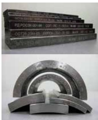
Плоские и трубные настроечные образцы (СОПы) с отражателями различного типа применяются для настройки длительности развертки и чувствительности дефектоскопов при контроле листовых и трубных изделий различных материалов и толщин. СОПы изготавливаются в соответствии с требованиями нормативной документации регулирующей порядок проведения УЗК в соответствующих областях промышленности.
