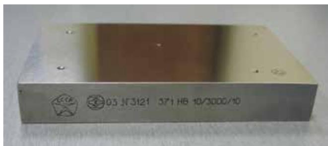
Комплект образцовых мер твердости по Бринеллю - МТБ-1 используется для проверки механических твердомеров по методу Бринелля. В отличие от метода Роквелла, измерение твердости по Бринеллю производят до упругого восстановления материала. Наконечник вдавливают в поверхность образца специальным прессом, через 30 секунд после приложения нагрузки
