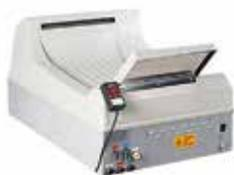
Автоматическая проявочная машина FNDX1 предназначена для быстрой и качественной обработки промышленной рентгеновской пленки, максимальной шириной до 36 см. Компактные габариты FNDX1 делают ее оптимальным устройством, как для работы в передвижных лабораториях, так и в стационарных лабораториях со средней производительностью. Помимо компактности, к преимуществам данной модели относятся: удобство и простота в эксплуатации и техническом обслуживании.
