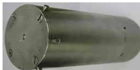
Диффузионная течь с баллоном ТДК-1 «Эксперт»
