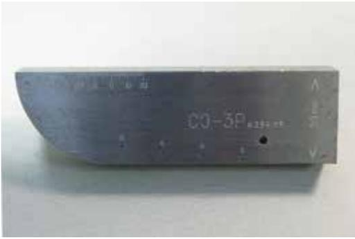
Образец (мера) СО-3Р предназначен для калибровки ультразвуковых дефектоскопов при контроле качества рельсов, а также деталей и узлов железнодорожного подвижного состава при совмещенной и раздельной схеме работы ПЭП и частоте более 1,5 МГц. Образец СО-3Р изготавливается из стали марки 20 в соответствии с требованиями [ГОСТ 18576-96](#). Комплект поставки: образец СО-3Р, паспорт, сертификат о калибровке.
