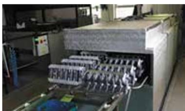
НТЦ «Эксперт» представляет автоматизированные линии капиллярного контроля производства чешской компании ATG. Основная область применения автоматических линий – поточный капиллярный контроль на предприятиях авиационной, автомобильной, машиностроительной и других отраслей промышленности. Линии пенетрантного контроля ATG соответствуют требованиям российских и зарубежных нормативов, в том числе [ГОСТ 18442-80](#), [ISO 3452-1](#) и [EN 571](#).
