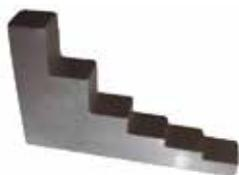
Стандартный образец типа «ступенька» предназначен для настройки толщиномеров перед проведением ультразвукового контроля. Образец изготавливается из стали марки Ст20 и алюминия. По заявке возможно изготовления образца из других материалов по размерам заказчика.
