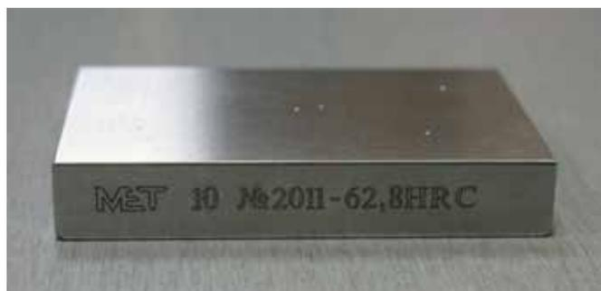
Комплект образцовых мер твердости МТР-1 используется для калибровки механических [твердомеров по методу Роквелла](#), являющегося наиболее простым и распространенным способом проверки твердости материалов. Сущность метода заключается во внедрении в поверхность изделия алмазного конусного или стального сферического наконечника с последующим замером глубины его проникновения, после снятия основного усилия. Основные характеристики образцов твердости из набора МТР-1 приведены в следующей таблице.
