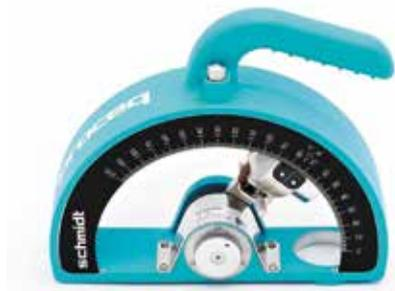
Маятниковые молотки Шмидта OS-120 используются для измерения прочности мягких материалов, таких как легкий и свежий бетон, гипсокартон и цементный раствор в кирпичной кладке. Молотки данного типа дают возможность проводить измерения на объектах с прочностью на сжатие от 1 МПа. Маятниковый механизм Schmidt OS-120 дает возможность проводить измерения на вертикальных и горизонтальных поверхностях.
