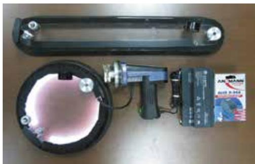
Течеискатель ТВП-12 «Эксперт» предназначена для контроля герметичности сварных соединений и основного материала в нефтегазовой, энергетической и других отраслях промышленности.
