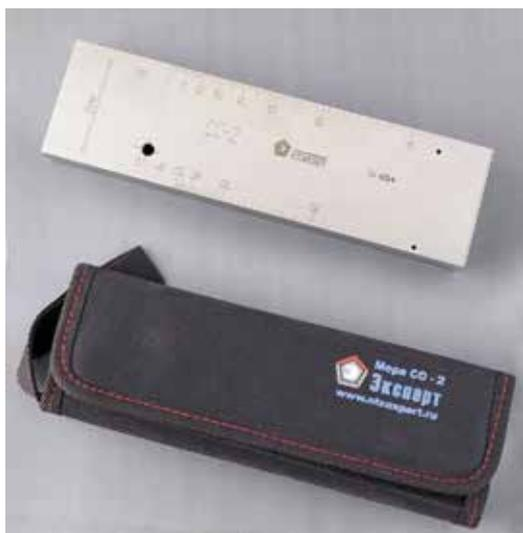
Мера (калибровочный образец) СО-2 изготавливается в соответствии с [ГОСТ Р 55724-2013](#) (взамен [ГОСТ 14782-86](#)). Данный норматив определяет геометрические размеры образцов и вводит понятие эталонный образец (мера) изготавливается из стали марки 20 по ГОСТ 1050. Геометрические размеры образца соответствуют [ГОСТ Р 55724-2013](#).
