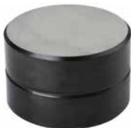
Образцы твердости HLD используются для калибровки твердомеров по методу Либа (Leeb). Измерение твердости по методу Leeb схоже с методом Шора, но здесь за меру твердости принимается не высота отскока бойка, а его скорость. Соответственно чем тверже материала, тем выше скорость отскока.
