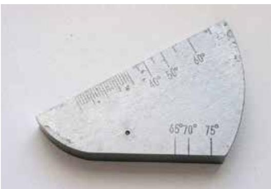
Мера (калибровочный образец) V2, он же K2, используется для настройки малогабаритных и миниатюрных преобразователей. По сравнению с калибровочным образцом V1 образец V2 имеет малый вес и габариты, однако из-за меньшего диапазона не предназначен для полной настройки дефектоскопов. Материал и акустические свойства образца V2, такие те как и у образца V1
