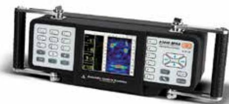
Ультразвуковой томограф А1040 МІRА это модернизированная модель томографа А1040М Полигон. Томограф А1040 МІRА предназначен для контроля конструкций из бетона, железобетона и камня при одностороннем доступе, с целью определения целостности материала в конструкции, поиска инородных включений, полостей, непроливов, расслоений и трещин, а также измерения толщины объекта.
