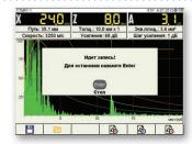
Возможность записи голосовых комментариев к сохраняемым кадрам с помощью беспроводной Bluetooth гарнитуры (2000 записей). В течение 20 секунд пользователь имеет возможность записать необходимую информацию об объекте контроля с привязкой к сохраненному А-скану.
