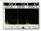
**АРД-диаграммы** для совмещенных преобразователей позволяют наблюдать на экране три кривые, которые соответствуют браковочному, контрольному и поисковому уровням. Расчет эквивалентной площади отражателя происходит автоматически.
