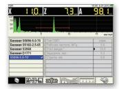
Энергонезависимая память (2000 изображений А-сканов с параметрами контроля). Отображение сигнала и его характеристик в верхней части экрана в режиме НАСТРОЙКА, позволяет оперативно подстраивать параметры контроля.
