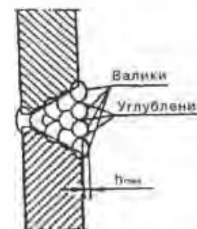
Рис. А34. Углубления (западания) между валиками шва
