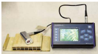
Рис. 7. Дефектоскоп ДАМИ-С09 с датчиком УДП-10-02Е
