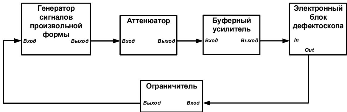
Рисунок 4 – Схема определения основных характеристик приемника дефектоскопа
