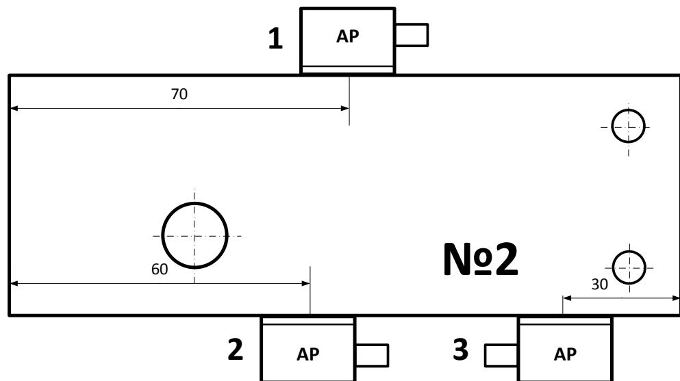
Рисунок 12 – Установка АР продольных волн M9171 4.0V0R26X10CL на образце СО-2
