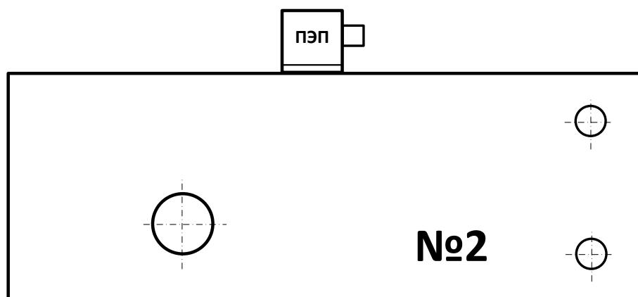
Рисунок 15 – Установка наклонного ПЭП на образце СО-2
