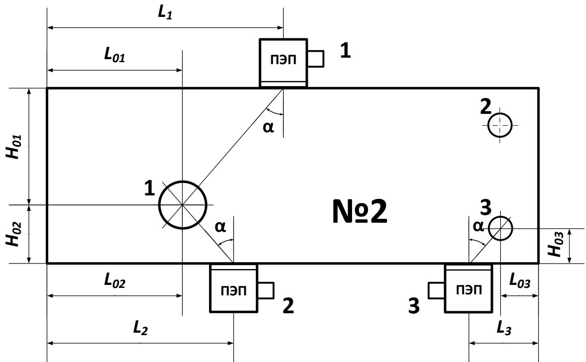
Рисунок 9 – Определение координат дефекта с наклонным ПЭП
