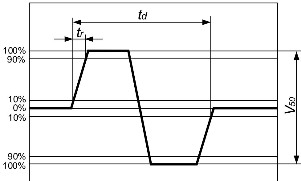
Рисунок 3 - Определение параметров генератора импульсов возбуждения
