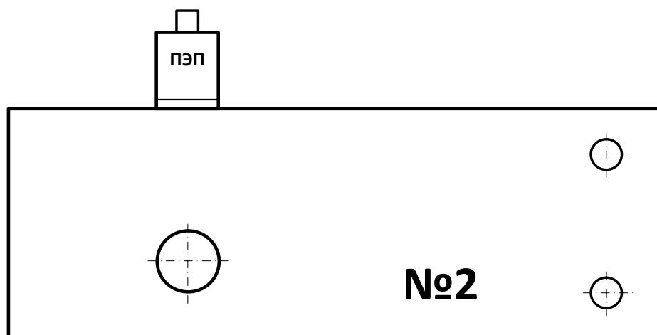
Рисунок 14 – Установка прямого ПЭП на образце СО-2
