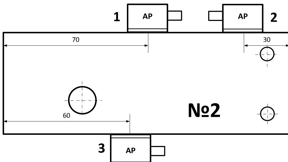
Рисунок 11 – Установка АР продольных волн M9060 4.0V0R40X10CL на образце СО-2
