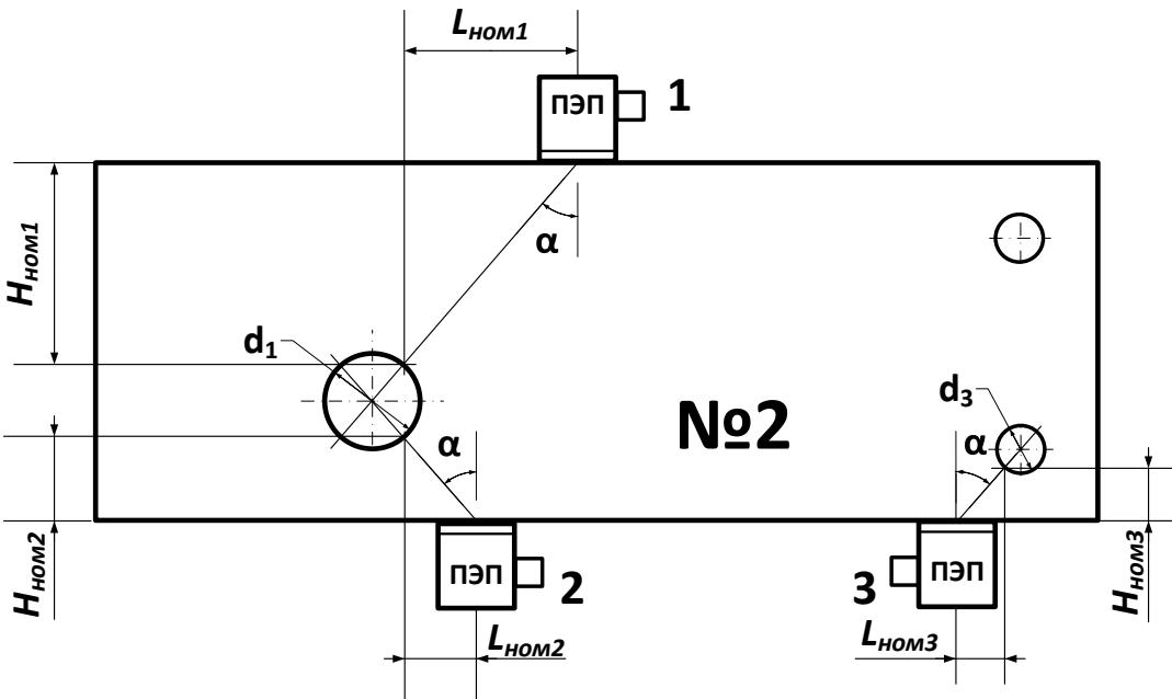
Рисунок 10 – Расчет номинальных значений координат дефекта
