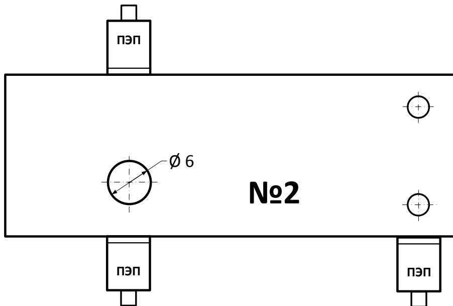
Рисунок 7 – Установка ПЭП D1771 4.0A0D12CL на образце СО-2
