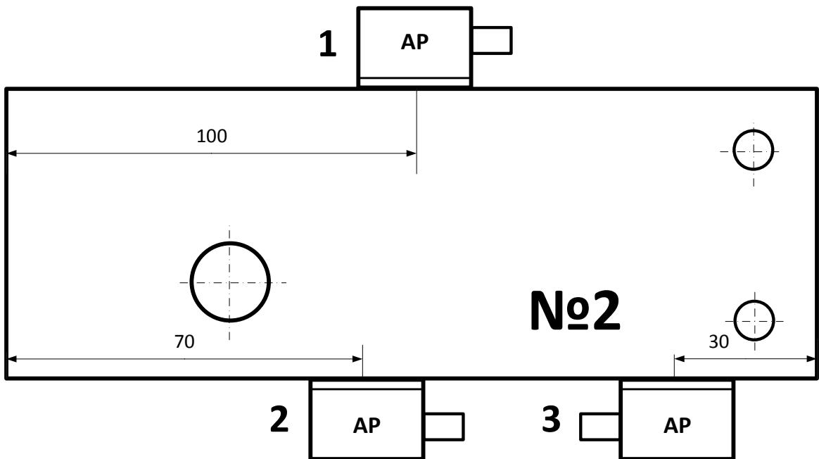
Рисунок 13 – Установка АР поперечных волн на образце СО-2
