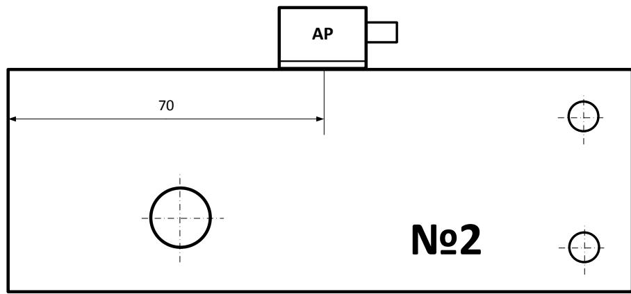
Рисунок 16 – Установка АР продольных волн на образце СО-2
