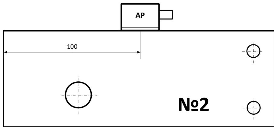
Рисунок 17 – Установка АР поперечных волн на образце СО-2
