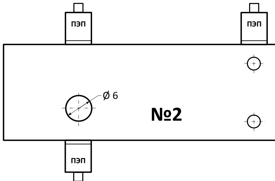
Рисунок 6 – Установка ПЭП S3568 2.5A0D10CL на образце СО-2
