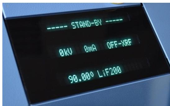
Рис. 13. Сообщение на дисплее спектрометра о готовности к дальнейшей работе
