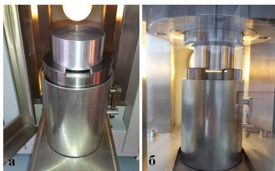
Рис. 75. Выпрессовывание пробы из пресс-формы
