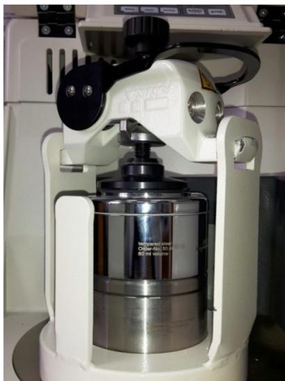
Рис. 64. Фиксация с использованием двух размольных стаканов объемом 80 мл
