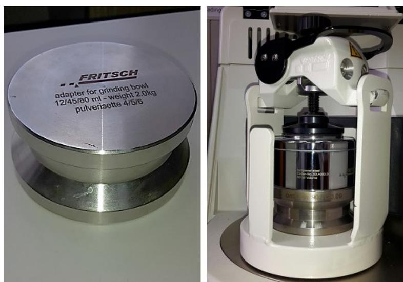
Рис. 63. Адаптер и его установка на размольный стакан (80 мл)
