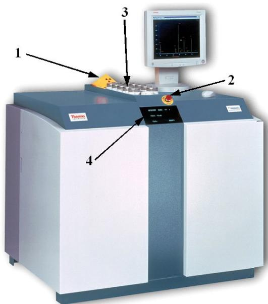
Рис. 2. Внешний вид спектрометра «ARL ADVANT'X 4200W»: 1 – лампа-индикатор работы рентгеновской трубки, 2 – кнопка аварийного выключения прибора «EMERGENCY STOP», 3 – лента для загрузки кассет с пробами, 4 – дисплей
