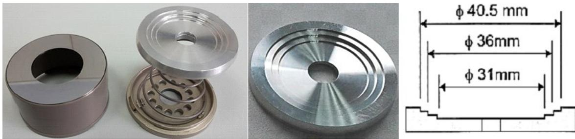
Рис. 22. Кассета и пружинная крышка для проб с центрирующим кольцом
