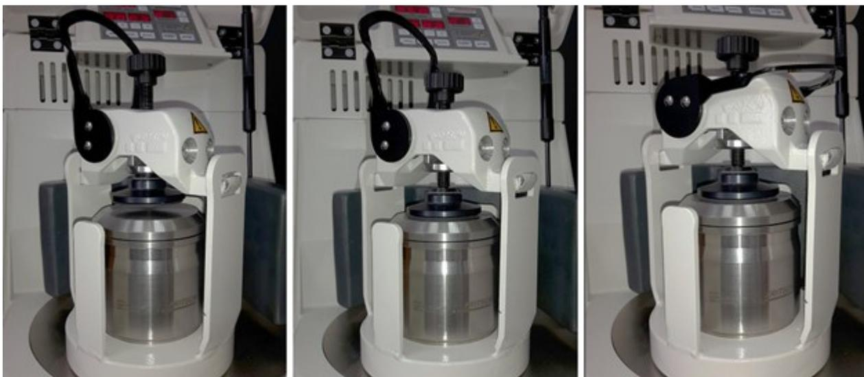
Рис. 62. Последовательная схема закрепления зажима «Safe Lock»
