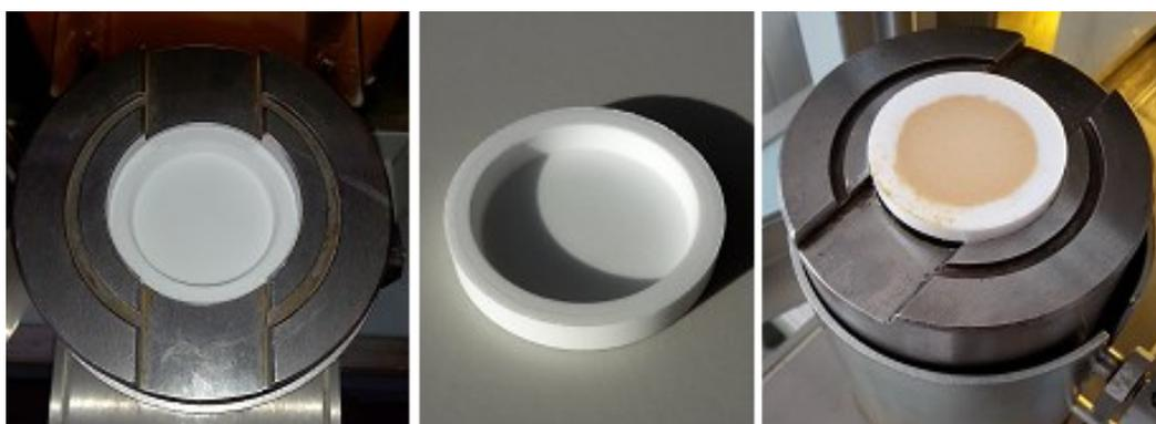
Рис. 74. Прессование подложки и пробы
