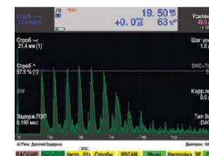
ВРЧ (временная регулировка чувствительности) необходима для выравнивания амплитуды сигнала с учетом расстояния до дефекта.
