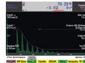
Кривая коррекции «амплитуда-расстояние». Функция, выполняющая построение кривой чувствительности по зоне контроля. DAC кривая это – линия, соединяющая максимумы эхо-сигналов (до 20 точек) от идентичных отражателей, расположенных на различном расстоянии. Позволяет эффективно производить отбраковку по всей области контроля с учетом затухания сигнала в материале.
