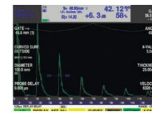
Является полезной функцией для контроля наклонными преобразователями продольного шва на криволинейной поверхности объекта.
