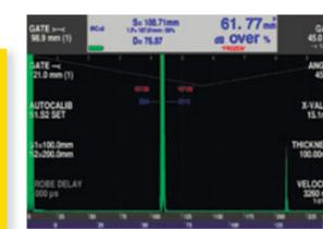
Автоматическая калибровка дефектоскопа под используемые преобразователи по стандартному образцу.
