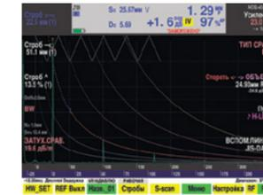
Данный метод определения размера дефекта основан на графическом изображении зависимости амплитуды отраженного или прошедшего сигнала от глубины залегания искусственной несплошности с учетом ее характерного размера.
