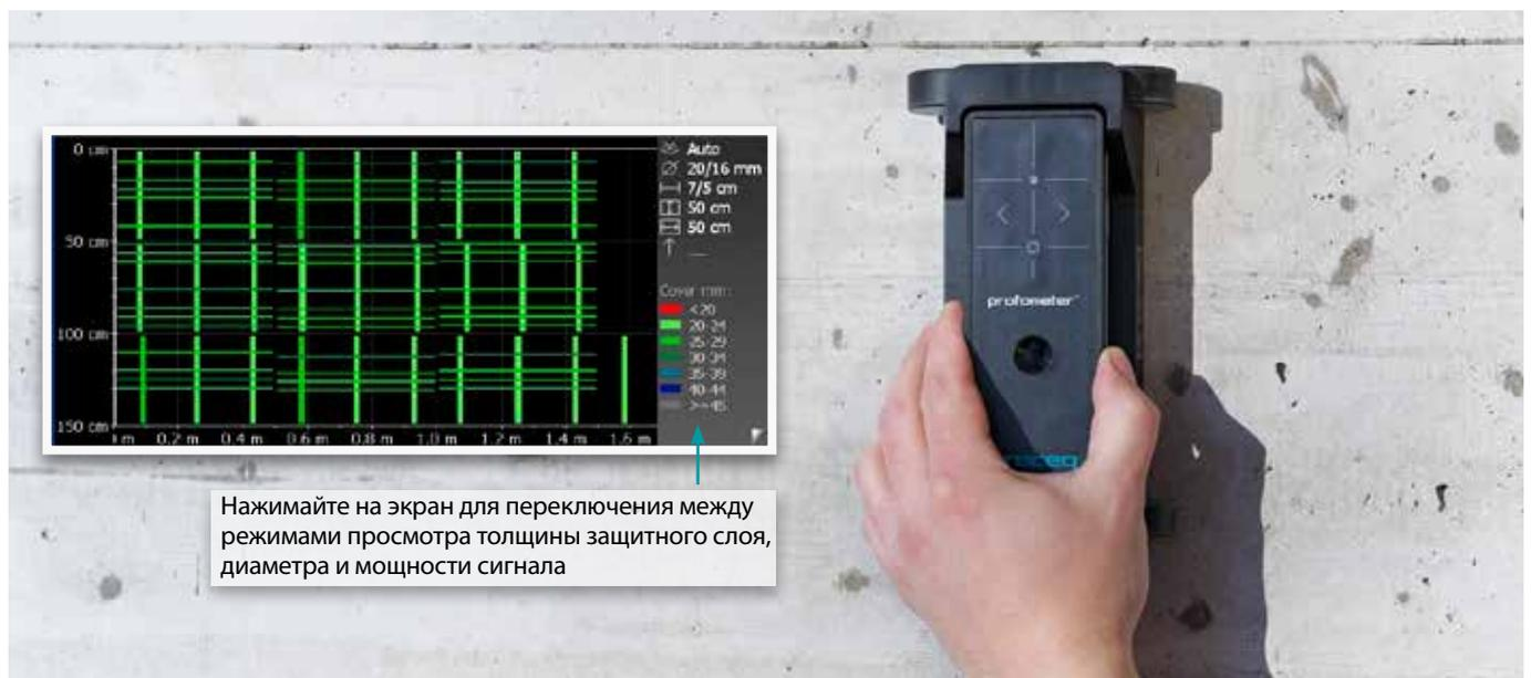
Нажимайте на экран для переключения между режимами просмотра толщины защитного слоя, диаметра и мощности сигнала
