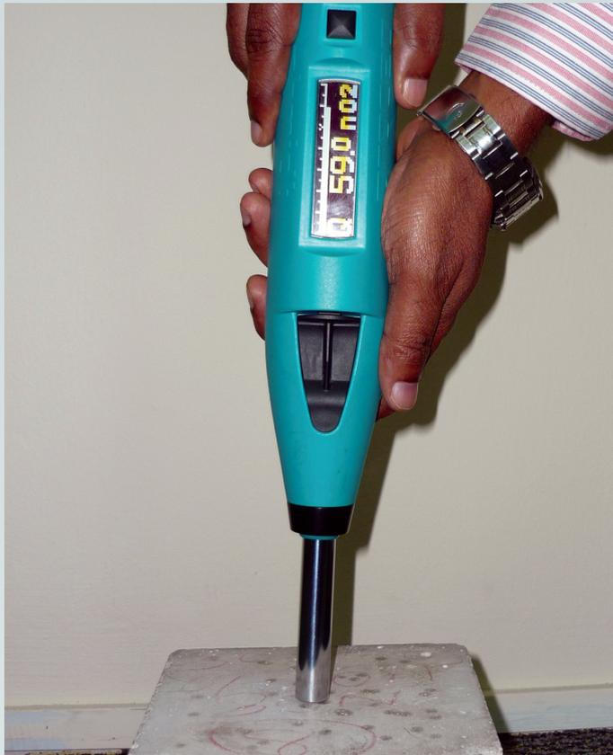
Тестирование предела прочности бетона при сжатии
