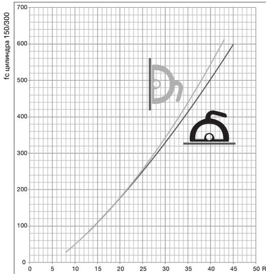
В случаях расчета прочности на сжатие для нестандартных размеров кубов или цилиндров (стандартные куб 150/150/150 или цилиндр 150/300) следует учитывать коэффициент формы. (Смотрите соответствующую информацию в документации, поставляемой с прибором, или на веб-сайте компании Proceq.)
