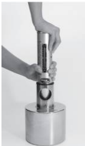
Рис. 3.1 Проверка технических характеристик молотка для контроля бетона (показан тип N/L)
