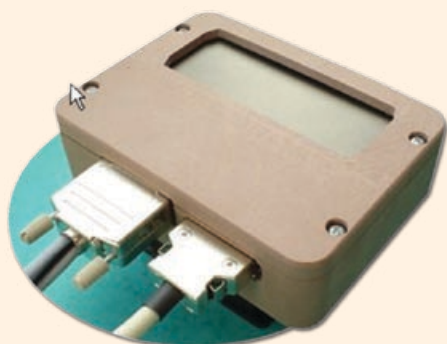
Рис. 5. Плоскостовый детектор DIC 100 прямого преобразования на CdTe производства компании Ajat
