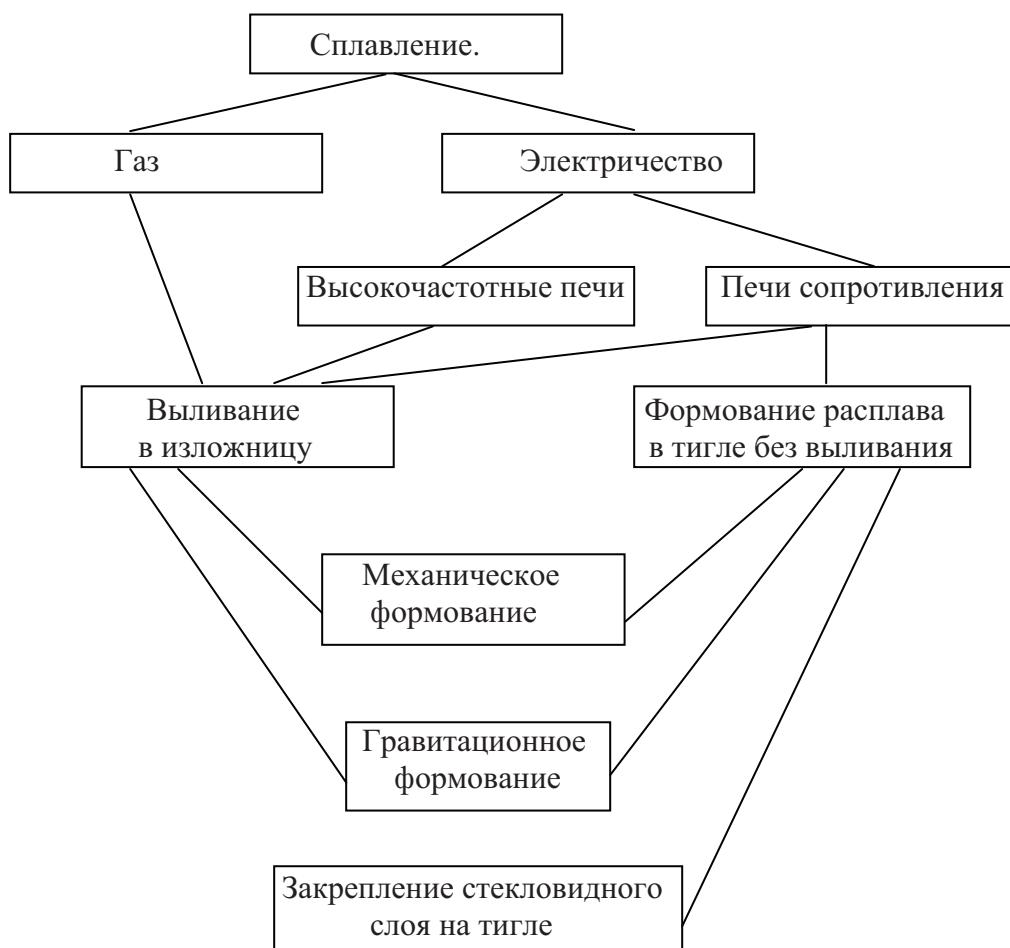
Схема аппаратурного оформления методик пробоподготовки сплавлением.
