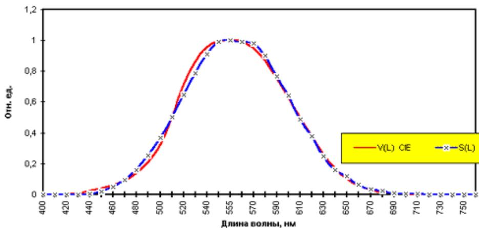
Рис.1 Относительная спектральная чувствительность прибора
