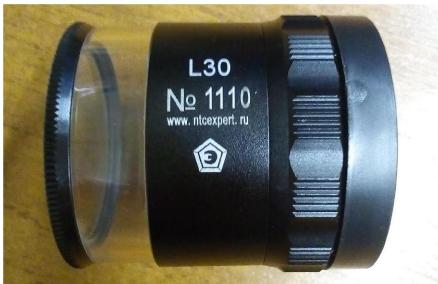
Рисунок 1 - Общий вид лупы измерительной ЛИ-3-10<sup>×</sup> с подсветкой (L 30)
