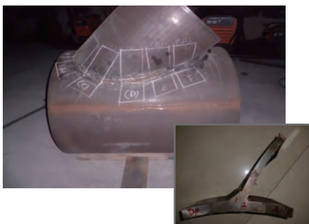
У-образный сварной шов, вырезанный из объекта контроля
