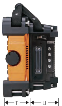
Системный модуль + 2 канала TOFD
