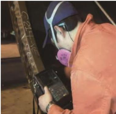
Прибор [CTS-9009PLUS](#) предназначен для увеличения продуктивности в различных ситуациях. Он позволяет найти место расположения и определить размер дефекта, и может применяться в широком ряде задач обнаружения, таких как работа с трубами с номинальным внутренним и внешним диаметрам, сварными швами, сосудами высокого давления и деталями самолетов. Примеры применения:
