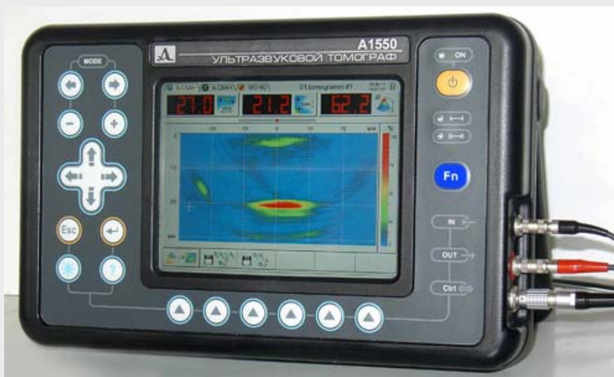
Рис. 9. УЗ томограф «A1550 IntroVisor™».
