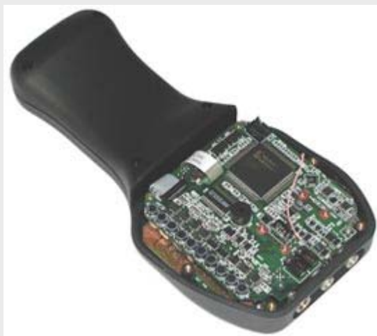
Рис. 9. Электронный отсек дефектоскопа A1212 МАСТЕР
