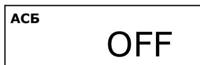
Кнопками изменения значений параметров включаем/выключаем автоматическую сигнализацию брака. При включенной АСБ и выходе измеренного значения за пределы установленных значений максимума и минимума, на индикатор выводится слово «БРАК».
