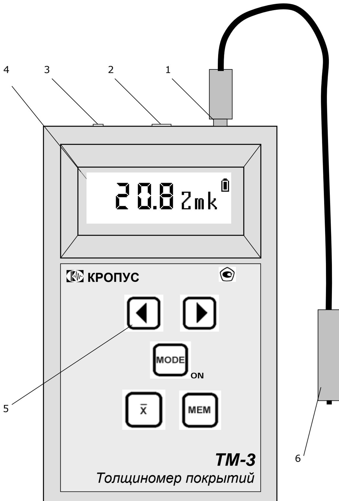
1 - разъем для подключения преобразователя; 2 - разъем соединения электронного блока с компьютером; 3 - разъем для подключения внешнего блока питания; 4 - жидкокристаллический индикатор; 5 - клавиатура; 6- измерительный преобразователь.
