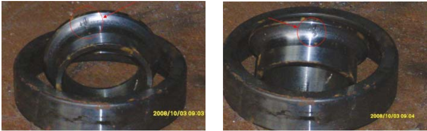
Рис. 2. Повреждения на внутренних кольцах подшипников качения
