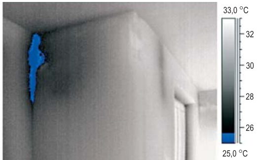
Рис. 6. Пониженная температура в верхней части стыка стеновых панелей
