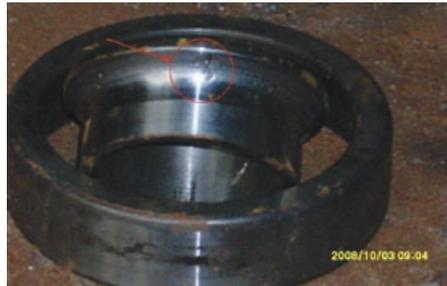
Рис. 2. Повреждения на внутренних кольцах подшипников качения
