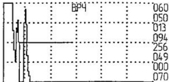
Усиление: 60 dB. Схема включения: совмещенная
