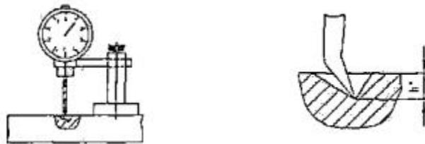
Рисунок Е.2 - Схема намерения глубины фрезерования сегмента
