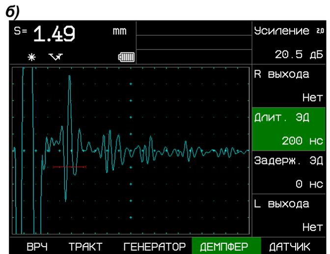
**Рис 2-8 Эффект применения электрического демпфирования ЗИ (преобразователь П111-10-К4 на образце 1,5мм)**
