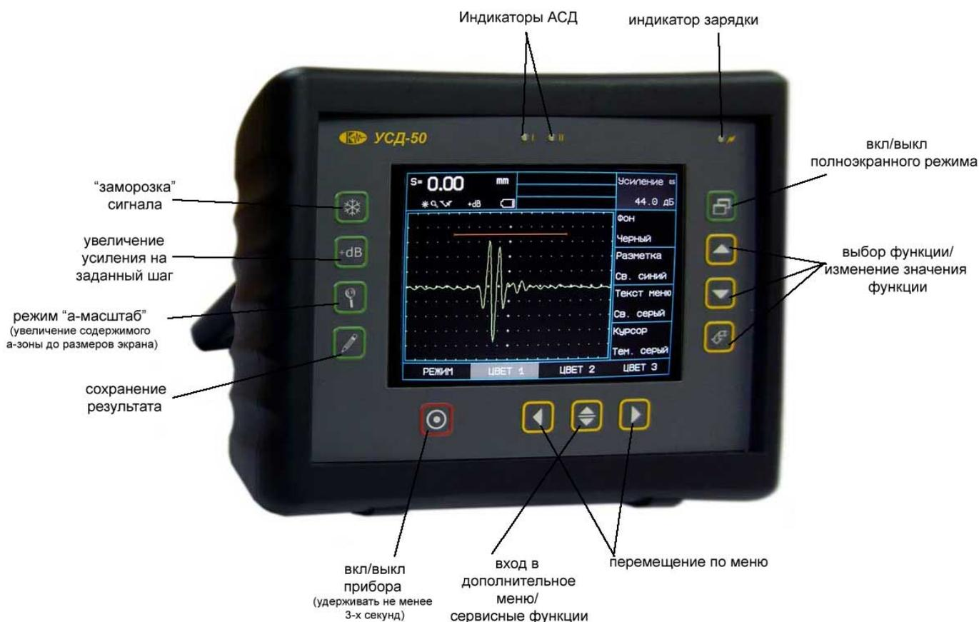
Рис 1-3—Клавиатура дефектоскопа
