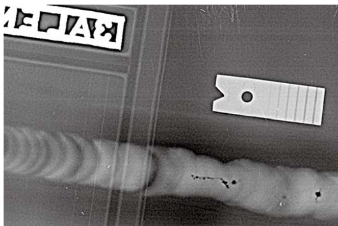
Рис. 4. Al 5 мм, снимок на пластину высокого разрешения. Вид после применения цифрового фильтра «Литьё»
