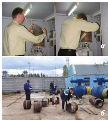
Рис. 2. Этапы проведения контроля: а — установка фосфорной пластины; б — рентгеноконтроль (аналогично традиционной радиографии)
