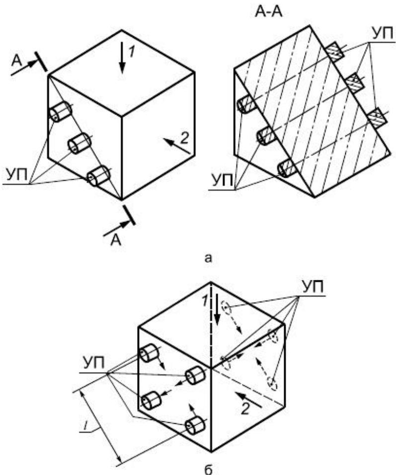
а - схема испытания образцов-кубов способом сквозного прозвучивания; б - схема испытания образцов-кубов способом поверхностного прозвучивания;
