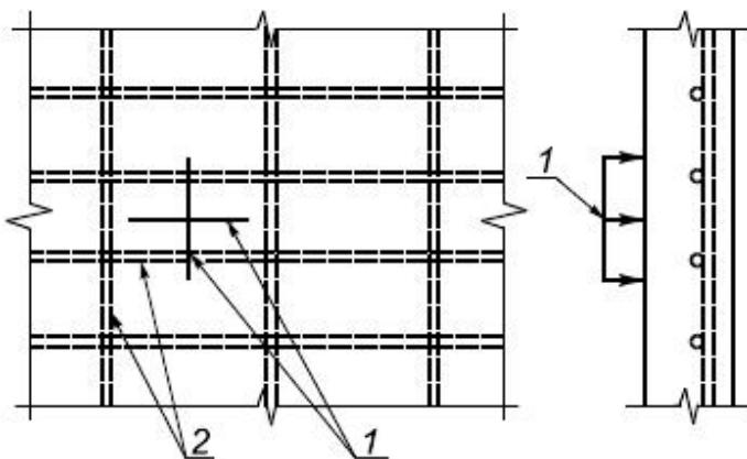
1 - положение прибора при испытании; 2 - расположение арматуры
