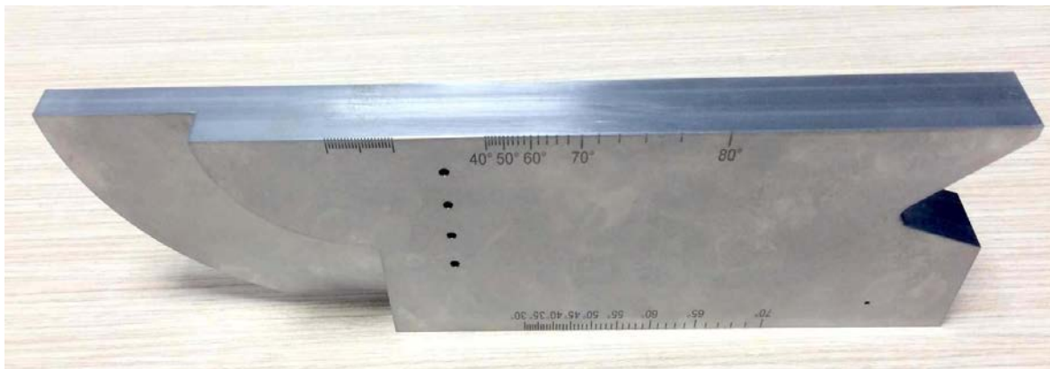
Рис. 6: Новый калибровочный образец для ультразвуковых систем с фазированной решёткой, изготовленный в соответствии с требованиями стандарта ISO 19675
