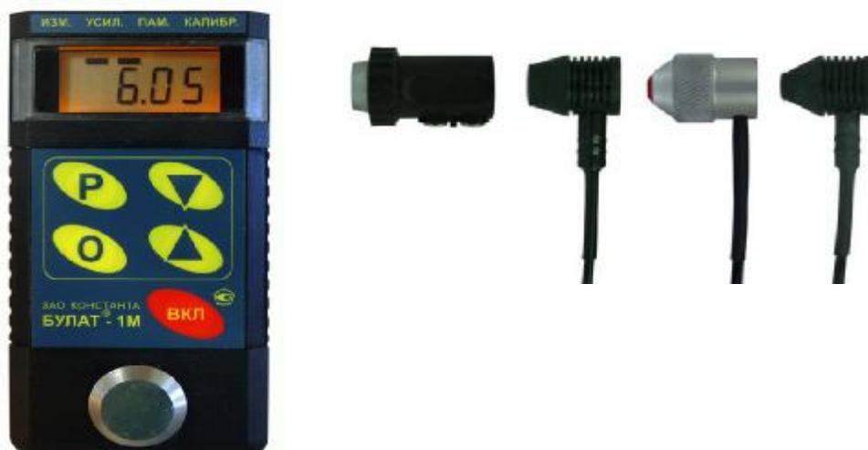
Рисунок 1 – Внешний вид блока обработки информации и преобразователей
