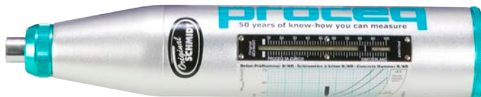
Рис. 4.9.2 Современный молоток Шмидта с пометкой «Original Schmidt» на корпусе
