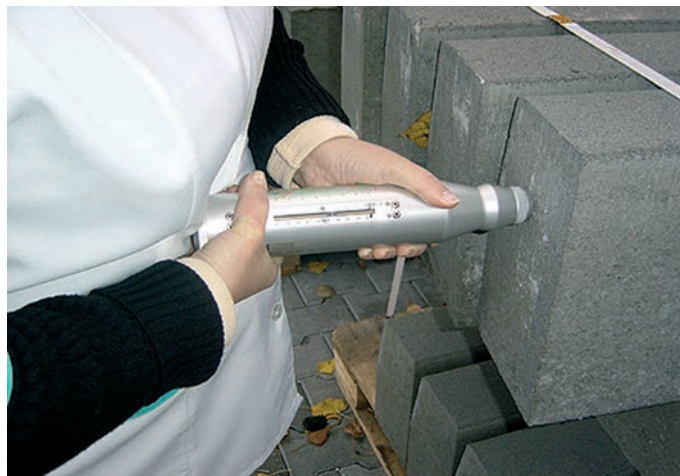
Рис 4.9.18 Положение молотка Шмидта в момент удара о поверхность
