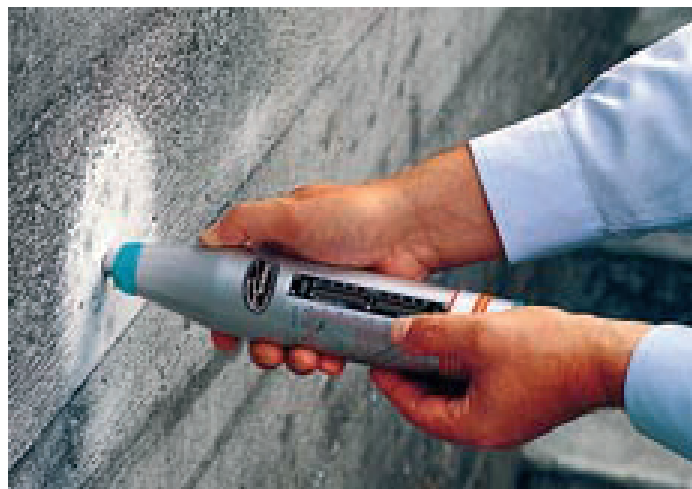
Рис. 4.9.15 Места испытаний равномерно распределяются по поверхности и помечаются мелом или используется специальный шаблон (см. рис. 4.9.7), чтобы избежать проведения испытания в одном и том же месте.
