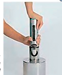
Рис. 4.9.14 Калибровочная наковальня для молотка Шмидта модели N
