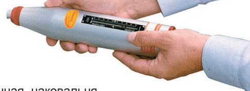
Рис. 4.9.13 Молоток Шмидта модели N перед использованием
