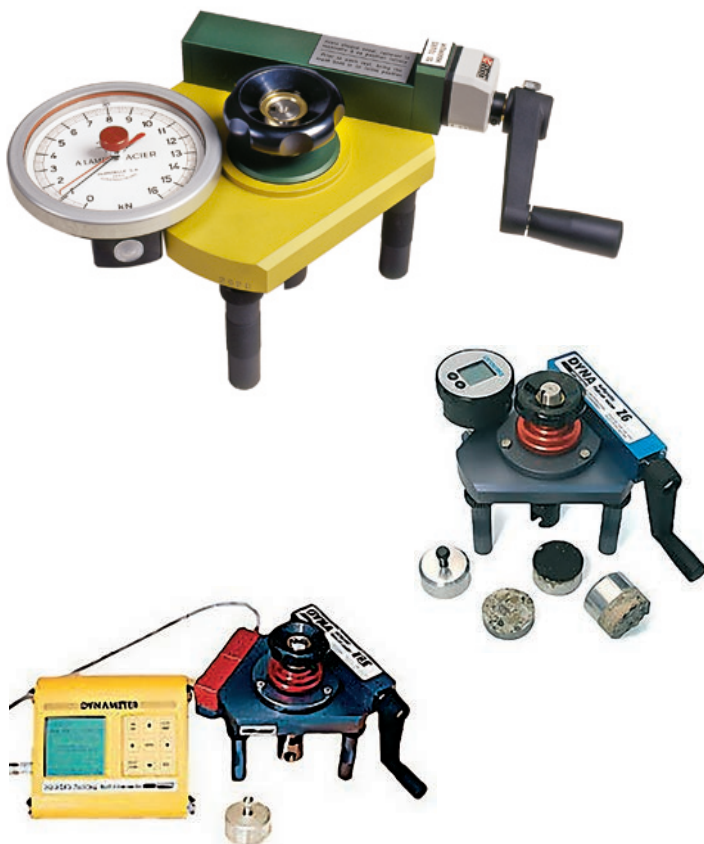
Рис. 4.11.1 Различные виды и конструкции прибора DYNA, используемые для определения прочности бетона на отрыв и измерения адгезии покрытий любого типа
