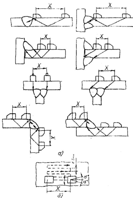
Рис.9 Сканирование при контроле сварных швов:
