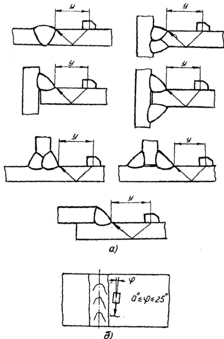
Рис.11. Сканирование при контроле окколошовных зон:
