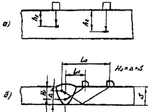
Рис.15. Координаты дефектов, выявленных прямым (a) и наклонным (б) ПЭП
