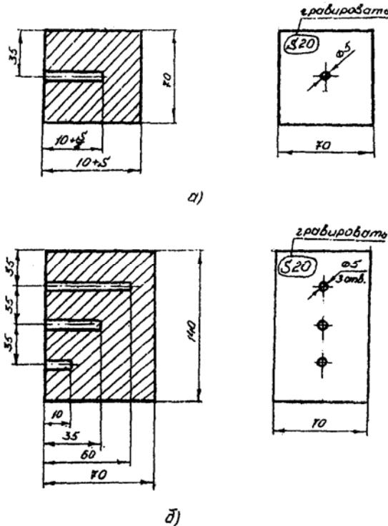
Рис.3. СОП для настройки дефектоскопа при контроле прямыми совмещенными и раздельно-совмещенными ПЭП при контроле околошовных зон и основного металла:
