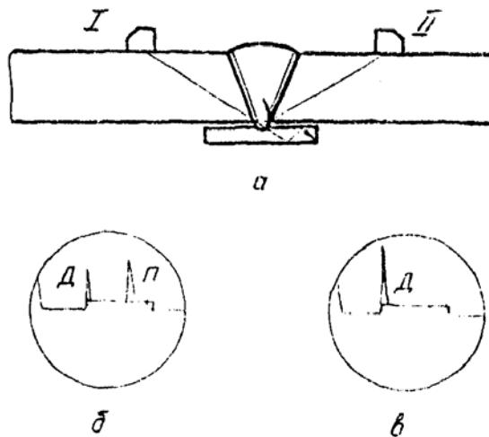
Рис 26. Схема обнаружения трещины в корне шва:
