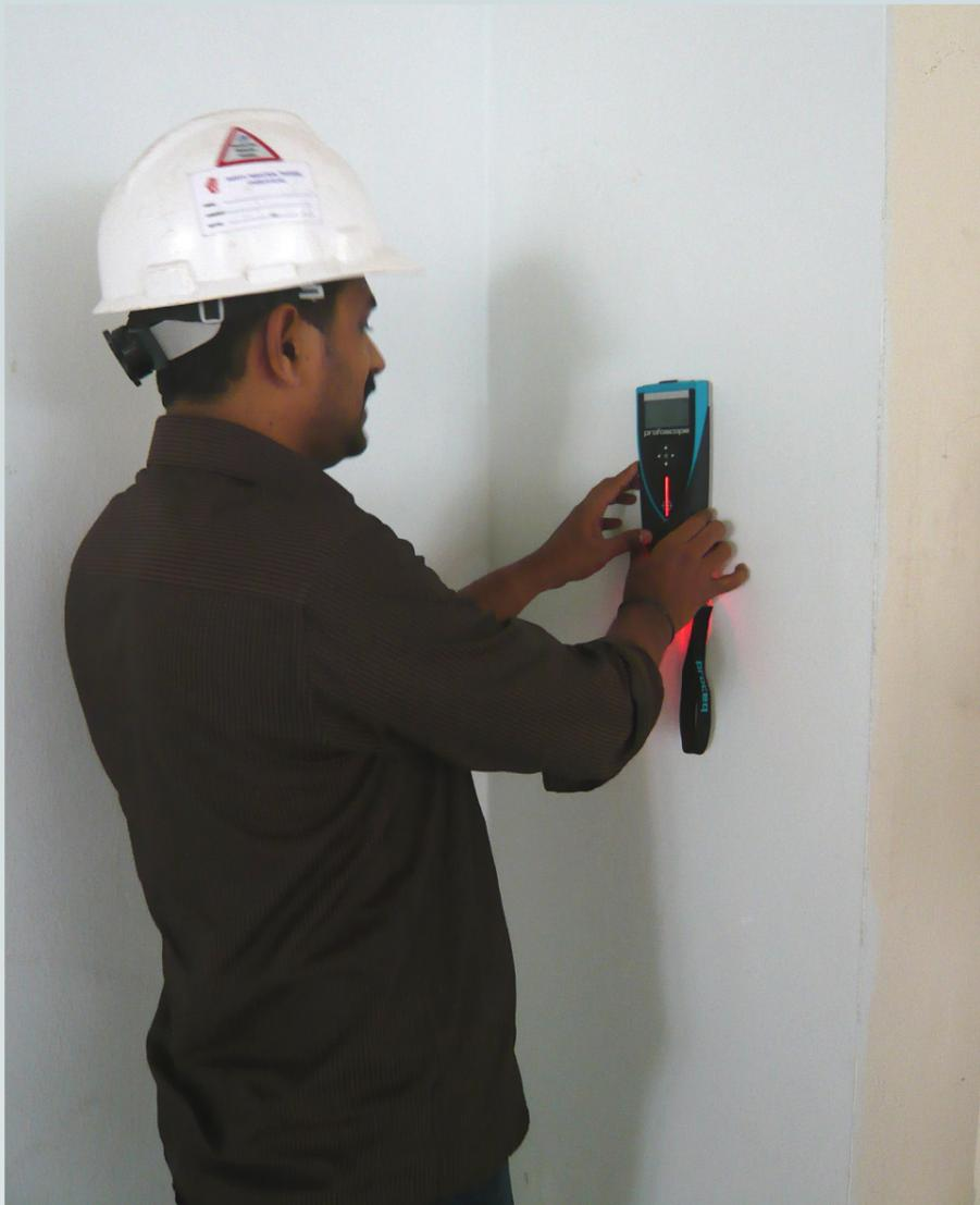
Индикатор арматуры и измеритель толщины покрытия
