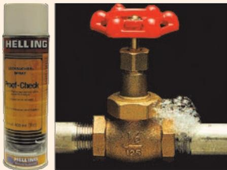
Рис. 2. Аэрозольный пенопеночный индикатор Proof Check, пример регистрации утечки
