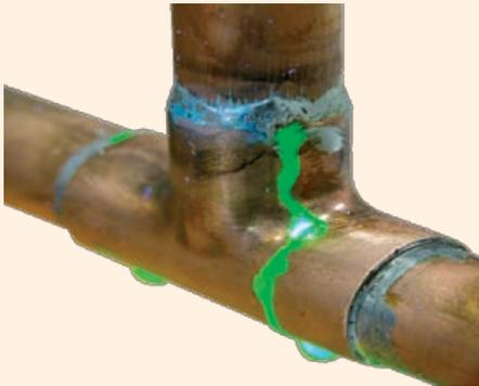
Рис. 6. Регистрация утечки в системе охлаждения с помощью флуоресцентного водорастворимого концентрата
