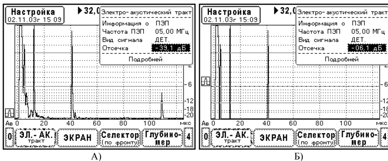
Рис.9.4.1.7. Установка уровня отсечки сигналов.
