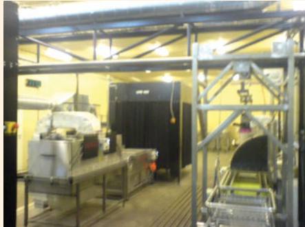
Рис. 3. Фрагмент линии капиллярного контроля LPM - 409
