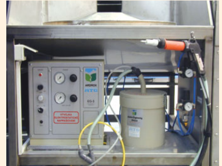
Рис. 7. Установка электростатического нанесения сухого проявителя
