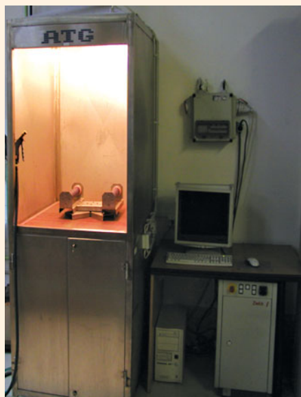
Рис. 11. Локальный участок капиллярного контроля
