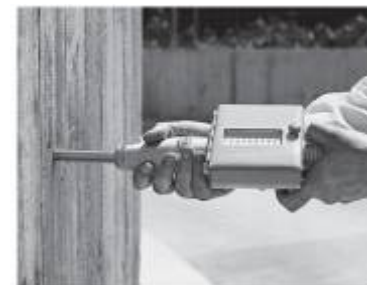
Рис. 2.2 Срабатывание ударного плунжера (1)
