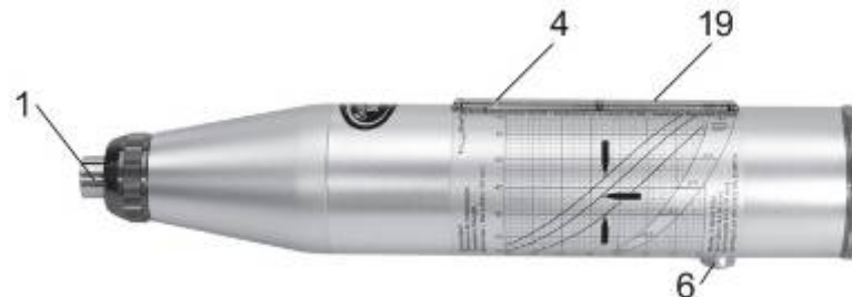
Рис. 2.4 Считывание результатов проведенного испытания по шкале (19) молотка
