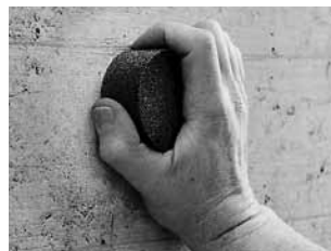
Рис. 5.1 Подготовка испытываемой поверхности
