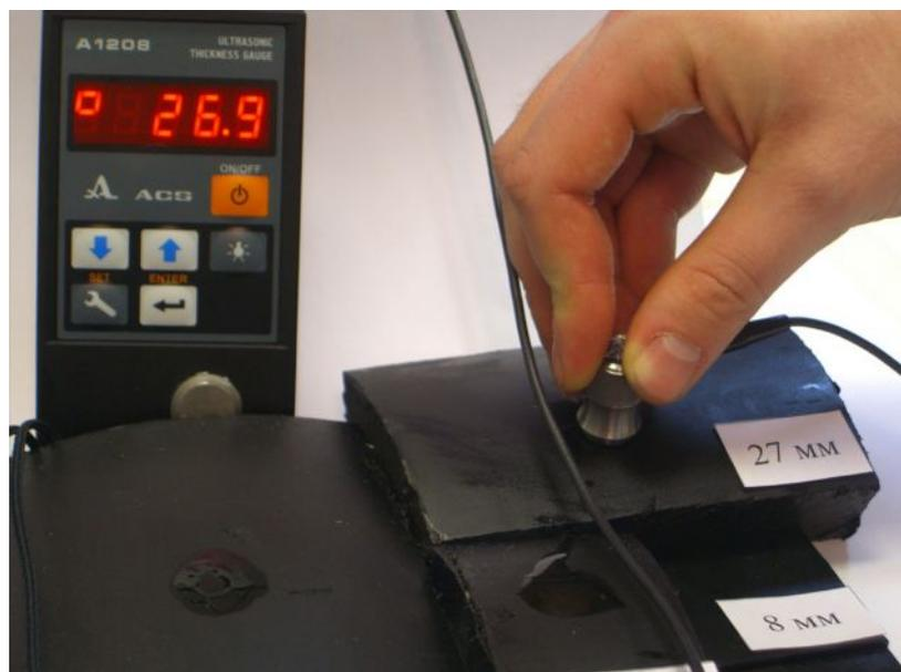
**На криволинейных поверхностях прибор работает также устойчиво, как и на плоскопараллельных поверхностях. Погрешность составила 0,1 мм.**
