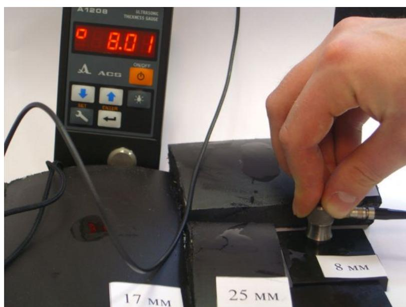
**4. Для примера поиска мест утонения материала, в бруске из полиэтилена был сделан неровный пропил.**
