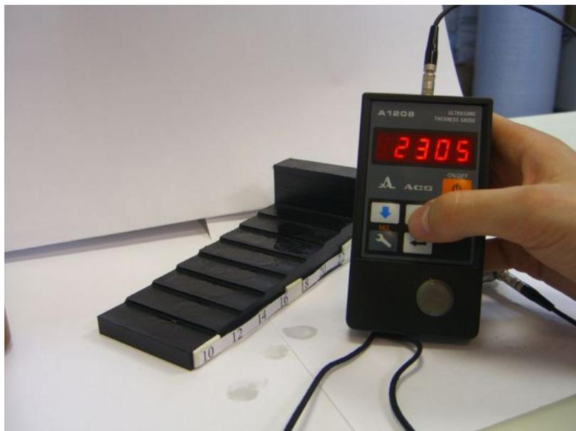
**При измерении толщин от 2 до 25-28 мм использовали преобразователь S3567 (2,5МГц). Измерения вели, начиная со ступени толщиной 10 мм. Под каждой из ступеней подписана реальная толщина в миллиметрах.**
