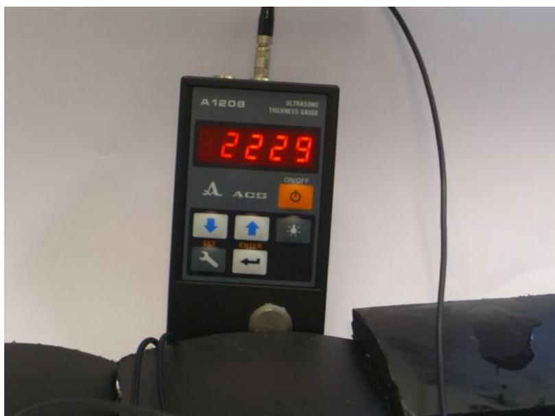
После чего мы провели измерения толщин этих образцов:
