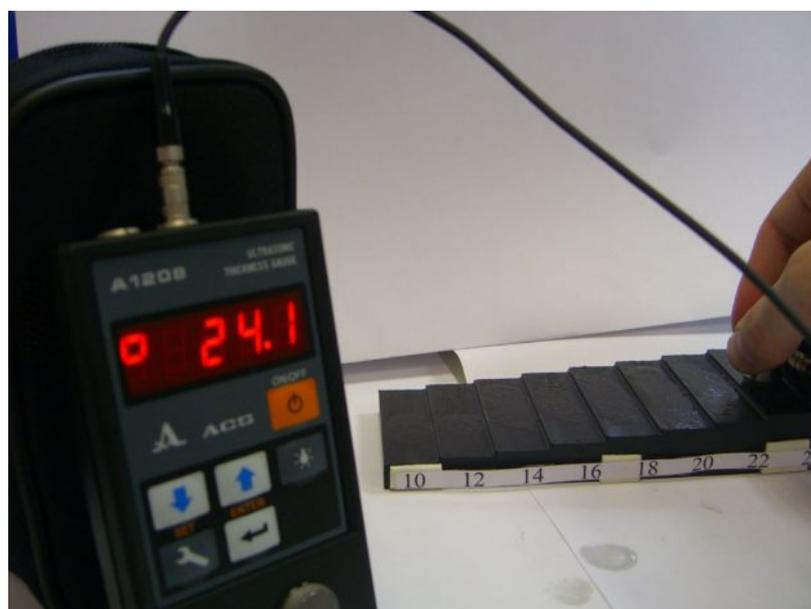
**Таким образом, мы убедились, что при измерении толщины плоскопараллельных образцов из полиэтилена толщиномер A1208 дает устойчивые показания во всем диапазоне от 10 до 24 мм. Погрешность измерения составила 0,1 мм.**
